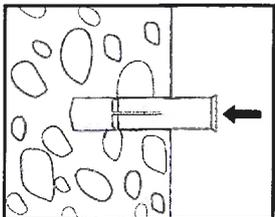
Der Dübel ist von Hand bzw. durch Schläge mit einem Hammer mindestens bündig mit dem Verankerungsgrund zu setzen.
