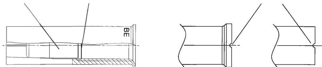
Einbauzustand: ungerissener Beton C20/25 bis C50/60
