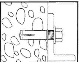
Bauteil befestigen, hierbei darf das angegebene maximale  $T_{inst}$  nicht überschritten werden.
