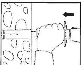
Durch das Einschlagen des Spreizstiftes mit dem Setzwerkzeug ist der Anker zu verspreizen.
